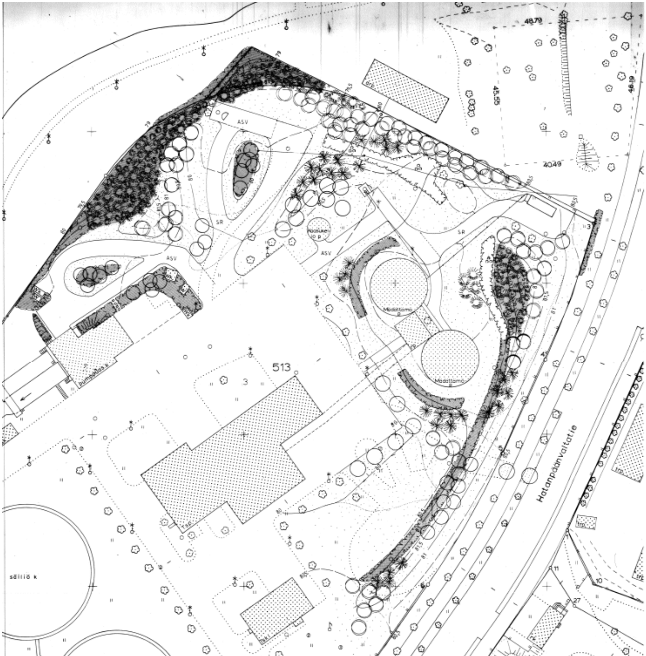
Puhdistamon pohjoisosan istutussuunnitelma 15.4.1986 (Pirkko Huttunen, Tampereen kaupungin puisto-osasto) sisältää havu- ja lehtipuita ja nykyistä runsaammin huoltoteitä. Tontin rajan pohjoispuolella Viinikan ensisuojan ensimmäinen rakennus. KUVA Tampereen kaupunki/puistotoimen arkisto
